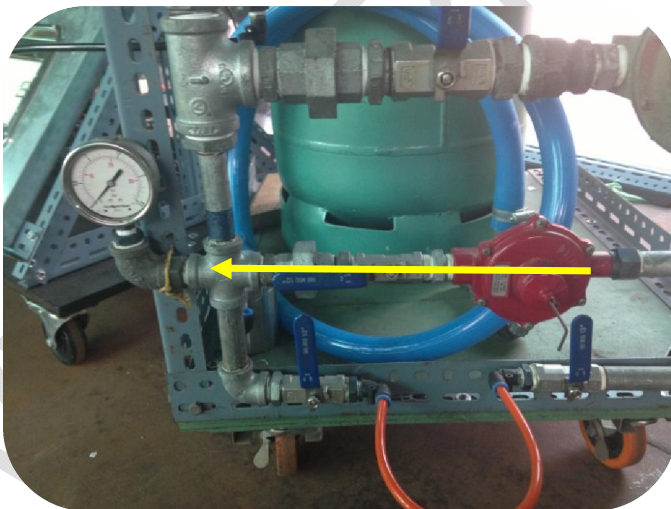
รูปที่ 8 แสดงการติดตั้ง Low Gas Pressure Regulator และ เกจวัดแรงดันก่อนเข้าสู่อุปกรณ์
